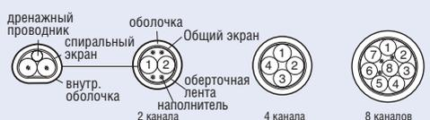
■ Определение канала: по пунктирной маркировке
