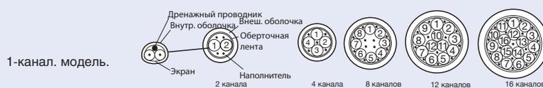
■ Цвет. маркировка каналов: сочетание цвета изоляции проводников и цветной полосы на каждом канале (каналы с 1 по 10 имеют красные полосы, с 11 по 16 – синие) на оболочке внутр. каналов (серого цвета)
