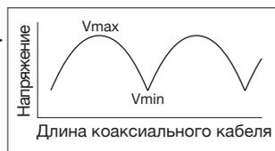
График 1. Распределение Напряжения по коаксиальному кабелю
