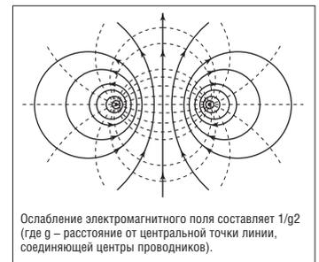
Рис. 2. Электромагнитное поле двухпроводного кабеля
