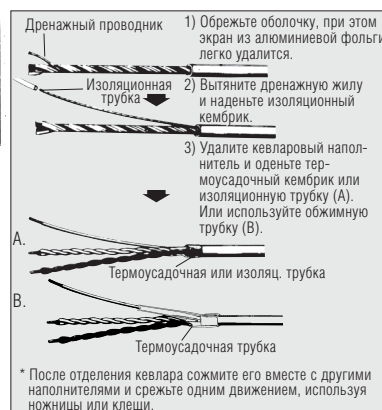
Рис. 4. Обрезка L-4E5AT и L-4E6AT
