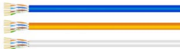
Витая пара – самый распространенный вид кабеля, используемый в локальных сетях. Кабель состоит из 4 пар изолированных проводников, скрученных в спираль и помещенных в изолирующую оболочку. Скручивание проводников в пару уменьшает электромагнитные помехи и взаимные наводки при передаче сигнала. Благодаря низкой стоимости и простоте монтажа витая пара подходит для самых разных видов коммуникационных технологий.
