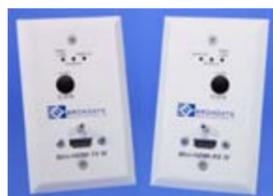
**Ряд Mini-HDMI-WP** - устройство передачи приема сигнала HDMI по одному многомодовому волокну. MINI-HDMI-WP передают HDMI сигнал, с сигналами HDCP/DDC, это позволяет передавать сигнал с разрешением WUXGA (1920\* 1200) или HDTV 1080p на расстояние до 400 метров. Крепление на стену.
