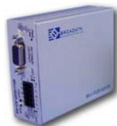
**Ряд Mini-RGB-AD-W** - устройство приема/передачи по многомодовому оптическому кабелю сигналов RGB, два аудио стерео сигнала (вход/выход) и два сигнала RS-232. Система позволяет передавать сигнал WUXGA (1920x1200) на расстояние до 400 метров. Устройства просты в установке и настройке, и совместимы с Mini-DVI-AD и Mini-HDMI-AD. Mini-RGB-AD-W поддерживает передачу сигнала WUXGA (1920x1200) или 720p/1080i/1080p HDTV.
