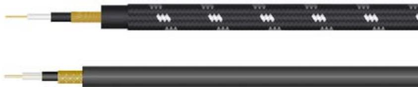
Несимметричный кабель, также называемый «инструментальным», применяется для передачи несимметричных сигналов линейного уровня, состоит из центрального проводника, диэлектрика, экрана и защитной изолирующей оболочки.
