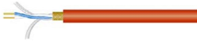
Симметричный кабель, известный также как «микрофонный» – основа звуковой коммутации. Он состоит из двух сквитых проводников, экрана и изолирующей оболочки.
