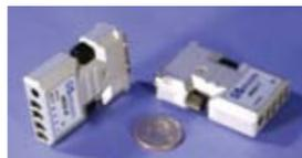
**Серия 4800/4802** – устройства передачи и приема сигналов DVI по оптоволоконным линиям на расстояния до 500 метров. Устройства 4800 передают сигнал по четырем многомодовым оптическим волокнам, устройства 4802 по двум многомодовым или одномодовым волокнам.
